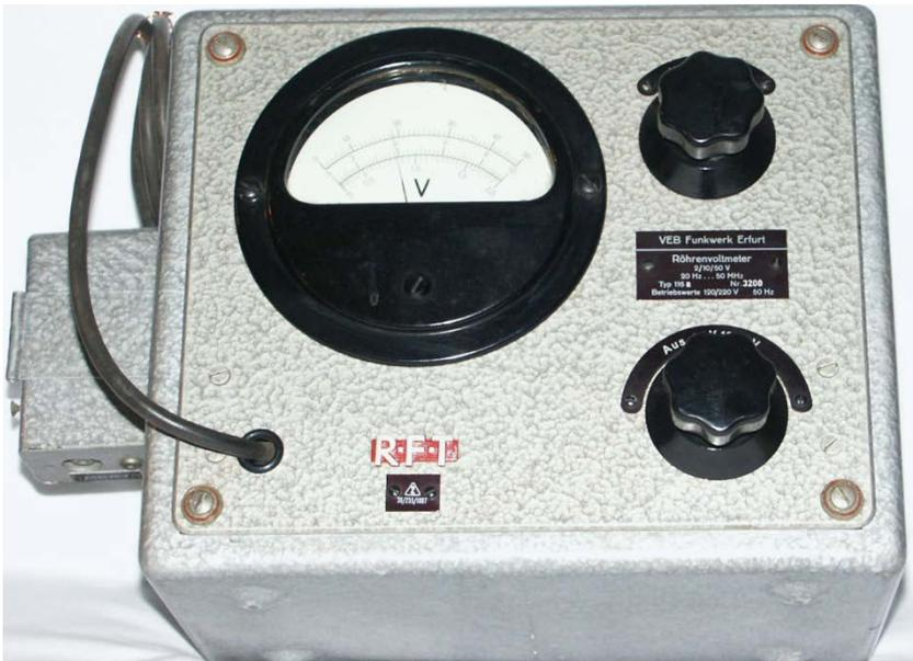
**Bezeichnung:** Röhrenvoltmeter Typ 116a
